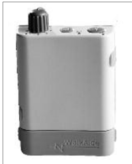
Abb. 1 Die Steuereinheit der Myoorthese WalkAide mit Ein-/Ausschalter und Intensitätsregler sowie integriertem Neigungs- und Beschleunigungssensor.
